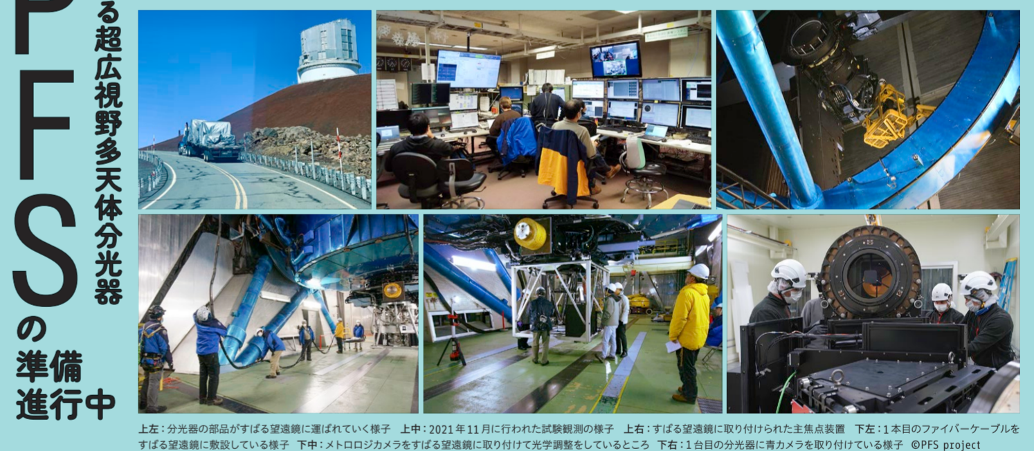
左上: 分光器の部品がすばる望遠鏡に運ばれていく様子 上中: 2021年11月に行われた試験観測の様子 右上: すばる望遠鏡に取り付けられた主集束装置 下左: 1本目のファイバースコープをすばる望遠鏡に接続している様子 下中: メトロロジカメラをすばる望遠鏡に取り付けて光学調整をしているところ 下右: 1台目の分光器に青カメラを取り付けている様子 ©PFS project
